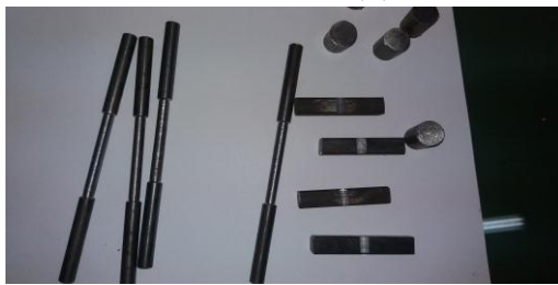
شكل (1) عينات اختبار البنية المجهرية والقساوة والشد والصدم.
