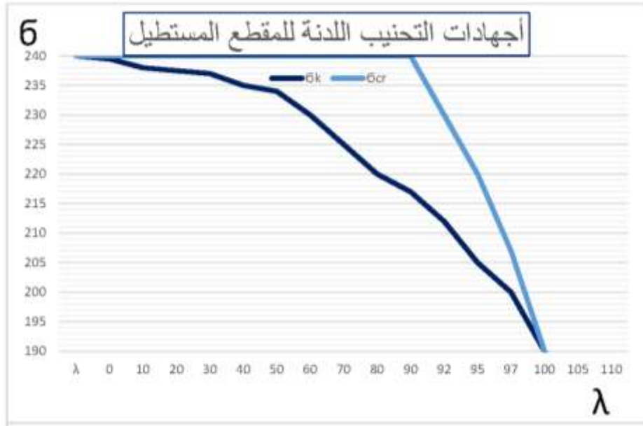
الشكل (11) مخطط علاقة إجهادات التحنيب اللدنة لعمود مستطيل المقطع مع النحافة
