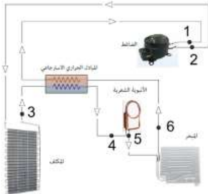
الشكل (1,d) مخطط دائرة التبريد
