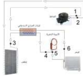
الشكل (1,d) مخطط دارة التبريد الجدول (3) مواصفات المجمدة المستخدمة في التجربة
