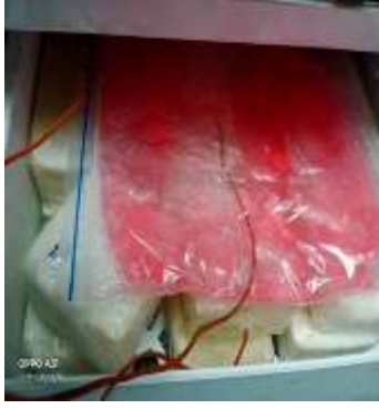
الشكل (8) توضع مادة التحول الطوري ضمن المجمدة
