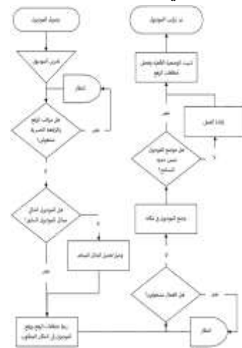
الشكل (17) مخطط التسلسل الأساسي لعمليات الرفع والتركيب للموديولات [232:16]
