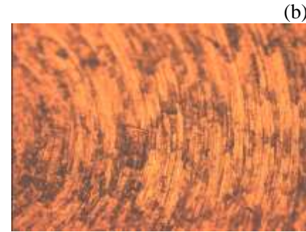
الشكل (8) صور المجهر الضوئي لـ NbN/SS304) الموضع عند 150 watt (a) قبل التآكل و (b) بعد التآكل بنسبة تكبير 250X
