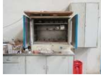
صورة/14/ توضح فرن التجفيف الحراري في المختبر
