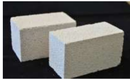
صورة 5/ توضح الخرسانة الخلوية المصنوعة من الطوب (الخلفية)، الخرسانة الخلوية المصنوعة من الأحجار الجيرية الرملية (الأمامية). [7].
