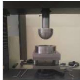
الشكل (7) صورة فوتوغرافية للعدّة المصنعة بعد تركيبها على آلة الاختبار
