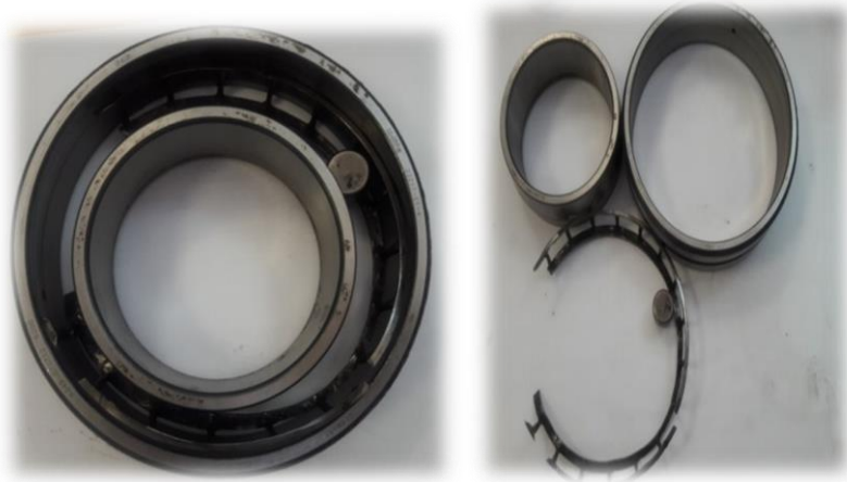
الشكل (2) المحامل التالفة (a)، "Bearing Failure" (b)
