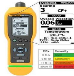
الشكل (4) جهاز قياس سرعة الاهتزاز والحرارة 805 Fluke
