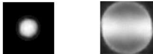
الشكل (12) صورة الضخ والليزر مأخوذتين من نهاية القضيب الليزري.
