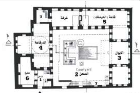
الشكل (1) مخطط ومقطع لدار باسيل بحلب مقياس 200/1- 1- المدخل، 2- الصحن، 3- الايوان، 4- الدرقاعة، 5- الحرملك، 6- الخدمك، 7- الأدرج.
