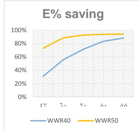
المخطط 8 علاقة الوفرة في الاستهلاك الكهربائي بنسبة نفوذية زجاج النوافذ
