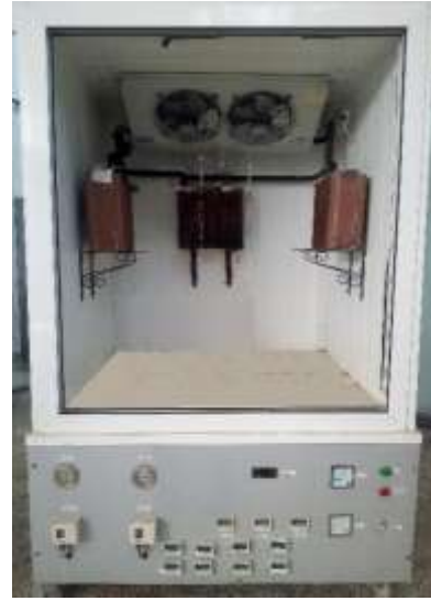
الشكل (4) مخطط تمثيلي وصورة لحجرة التبريد والمبادلات المنفذ
