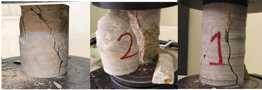
الشكل (2) شكل الانهيار في تجربة الضغط أحادي المحور للعينات الدولوميتية 1 و 2 و 5
