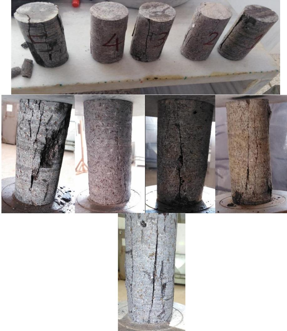
الشكل (5) شكل الانهيار في تجربة الضغط أحادي المحور للعينات البازلتية
