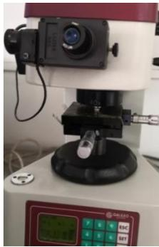
الشكل (٣) جهاز قياس القساوة الميكروية نوع Galileo
