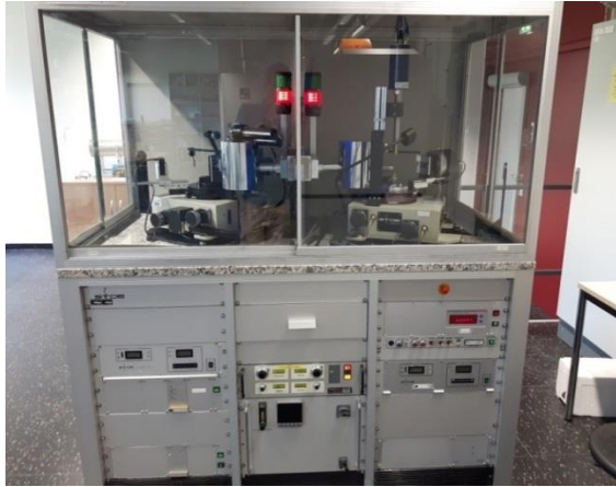
الشكل (٣) جهاز Stadi P لقياس انعراج الأشعة السينية XRD
