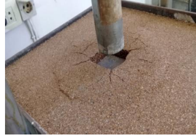
الشكل رقم (12) اختبار التحميل للعيونة بدرجة إشباع S=20%
