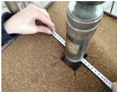
الشكل رقم (18) اختبار التحميل للعيونة بدرجة إشباع S=50%
