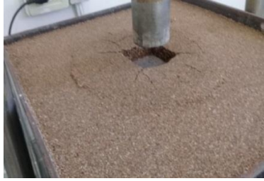
الشكل رقم (16) اختبار التحميل للعيونة بدرجة إشباع S=35%
