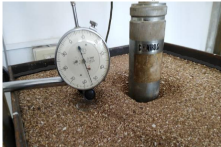
الشكل رقم (10) اختبار التحميل للعينة الجافة S=0\%
