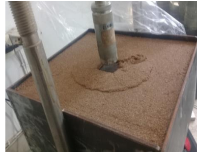
الشكل رقم (14) اختبار التحميل للعيونة بدرجة إشباع S=25%
