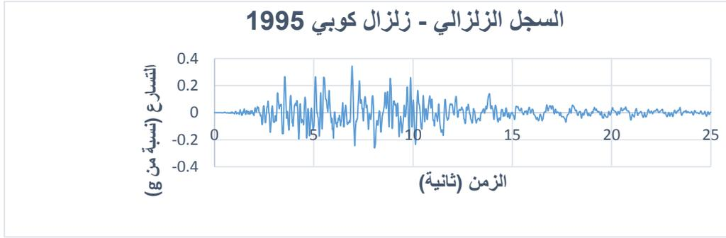
الشكل (4) يبين السجل الزلزالي لزلزال كوبي
