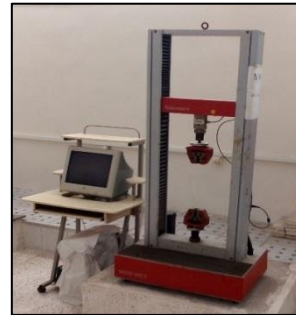
الشكل (5) جهاز اختبار الشد وعينة الشد
