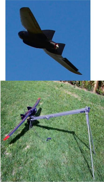
الشكل(1): درون ثابت الجناح : FlyGeo® مزود بألة تصوير رقمية Mpx 24 وسرعة وسطية أثناء التصوير 39 km/h ووزن 2.8 kg .
