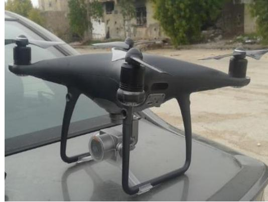
الشكل (2): درون متوسط الحجم ذو ستة محركات دوارة : FlyNovex hexacopter بوزن 6 kg، ودرون ذو أربعة محركات: PHANTOM 4 بوزن 1.38 kg - مثالين نمطين عن الدرونات المستقرة المستخدمة في المساحة التصويرية.
