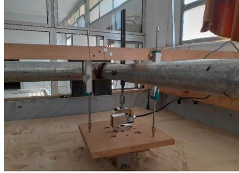
الشكل (10) تثبيت ذراع التحميل وحساس الانتقال وخلية قياس الحمل فوق النموذج.
