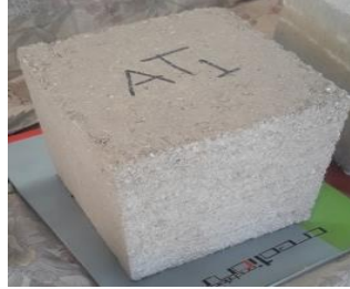
الصورة (14)، العينة AT1، المعادلة ب 6% اسمنت المعدة لاختبار الامتصاص، الباحثة.
