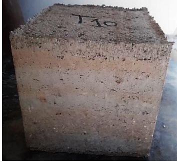
الصورة (13)، عينة معادلة بالكلس المطفأ والاسمنت (طبقة- طبقة)، الباحثة.
