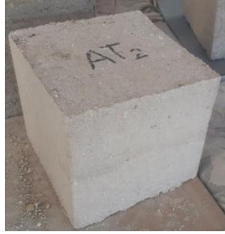
الصورة (15)، العينة AT2 المعادلة ب 6% كلس المطفاً المعدة لاختبار الامتصاص، الباحثة.
