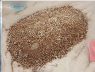
الصورة (8)، تصنيع خلطة التراب والقش، طبقة تربة- طبقة قش، وتركها تختمر 24 ساعة، قبل خلطها وتجهيزها للدك، الباحثة.
