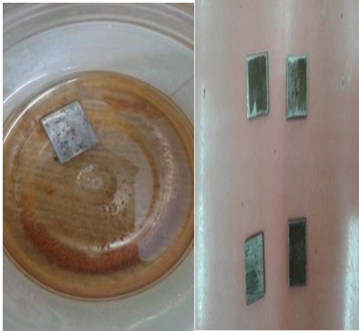
الشكل (2) عينات الفولاذ واختبار التآكل.
