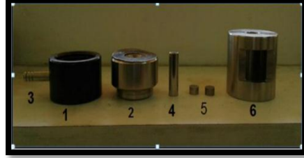
الشكل (2) قالب العينات الأسطوانية بقطر (10 mm).
