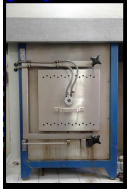
الشكل (4) فرن المعالجة الحرارية الكتيم.
