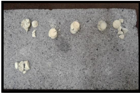
الشكل (6) عينات ( 70\%Ti-30\%Zr-50\%NH_4HCO_3 ) بعد التلييد عند (1300°C).
