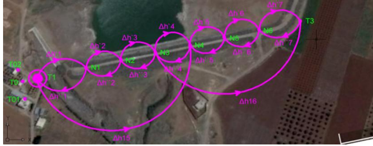
الشكل (10) شكل شبكة المراقبة الإرتفاعية المقترحة في سد طفس والحالة الثانية للقياسات
