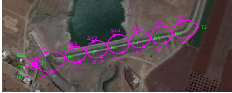
الشكل (9) شكل شبكة المراقبة الإرتفاعية المقترحة في سد طفس والحالة الأولى للقياسات
