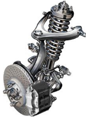
الشكل (1): نظام التعليق المستقل لإحدى عجلات السيارة.
