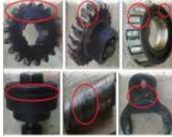
الشكل (5) التشوهات والعيوب في الأجزاء الداخلية لوحدة نقل القدرة في النموذج الأساسي بسبب الاهتزازات
