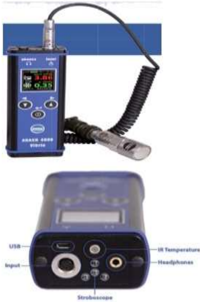
الشكل (7) جهاز قياس وتحليل الاهتزاز في أجزاء آلية نقل القدرة إلى مضخة تزويد الطائرات بالوقود Adash4900Vibrio
