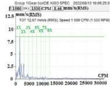
الشكل (19) طيف الاهتزاز عند القياس على علبه السرعة في النموذج المعدل لآلية نقل القدرة عند (1500r.p.m)
