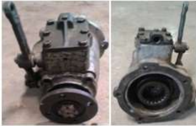
الشكل (10) وحدة نقل القدرة PTO الجديدة البديلة في النموذج المعدل لآلية نقل القدرة إلى مضخة تزويد الطائرات بالوقود
