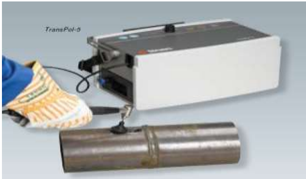
الشكل (4) التجهيزات المستخدمة لأخذ اللصاقة (مأخوذة من الدليل الإرشادي الإلكتروني للتجهيزات)
