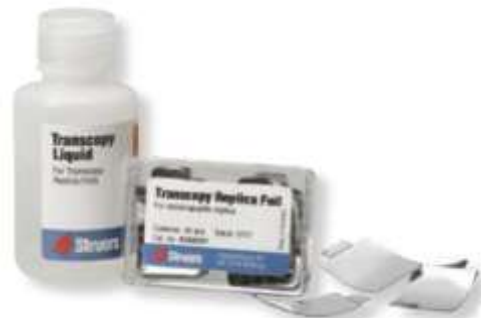
الشكل (4) التجهيزات المستخدمة لأخذ اللصاقة (مأخوذة من الدليل الإرشادي الإلكتروني للتجهيزات)
