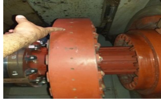
الشكل (11) يبين مستوى الموازنة ومكان توضع كتل الموازنة.
