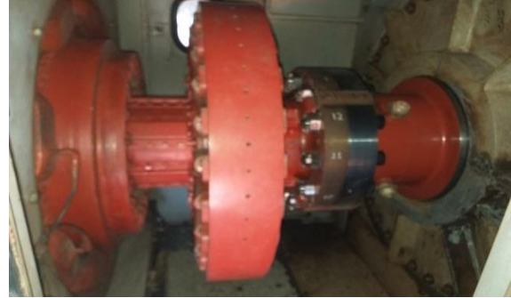
الشكل (10) يبين المحمل المهتز ومستوي الموازنة القريب منه
