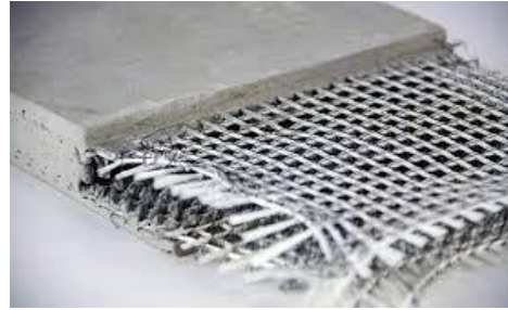
الشكل (11) الخرسانة المدعمة بالألياف المركبة (Bajad 2023)
