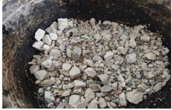
الصورة (13) شكل التصاق النفايات البلاستيكية بالحصويات
