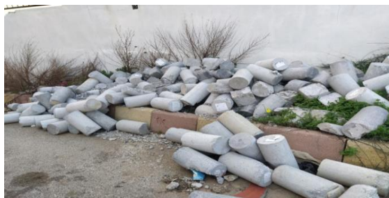
الصورة (1) النفايات الخرسانية قبل تكسيرها
