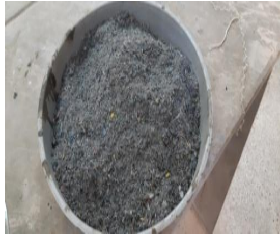
الصورة (5) النفايات البلاستيكية الناعمة بعد تقطيعها
