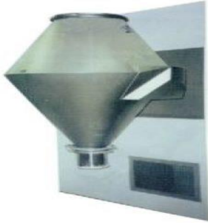
الشكل (3) خلاط ثنائي المخروط سعته 800 لتر بالتثبيت على الجدار (شكل المخروط غير قياسي)
