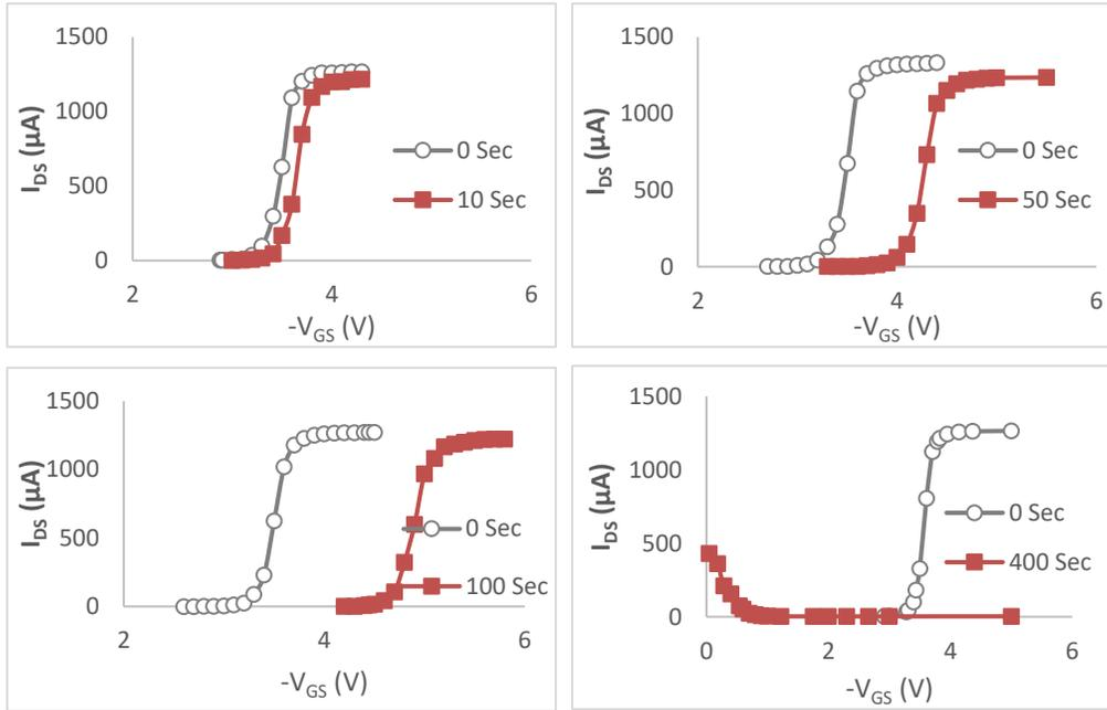
الشكل 4: المنحنيات المميزة  $I_{DS}-V_{GS}$  لأربعة عينات من النوع P-MOSFET شُعت داخل المفاعل خلال أزمنة مختلفة مبينة على كل شكل
