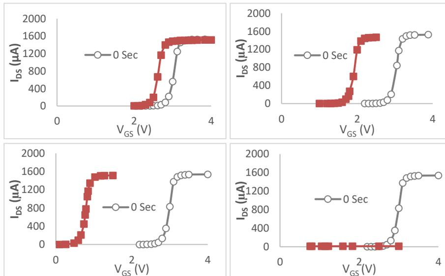
الشكل 6: المنحنيات المميزة  $I_{DS}-V_{GS}$  لأربعة عينات من النوع N-MOSFET شُعت داخل المفاعل خلال أزمنة مختلفة مبينة على كل شكل
