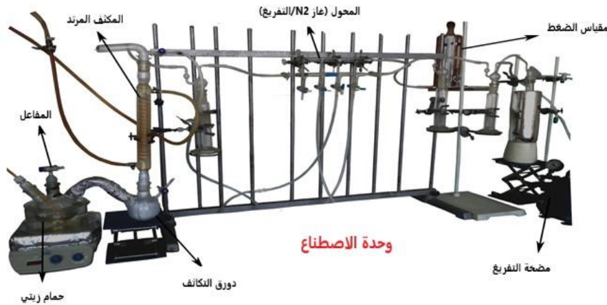
الشكل (4): منظومة الاصطناع المستخدمة في تحضير البوليمرات المرحلية والتشاركية وأجزائها الرئيسية.
