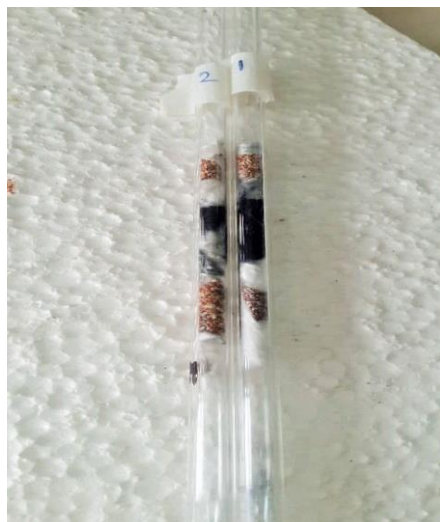
الشكل (14): صورة المفاعلين المستعملين للمعالجة الحرارية، الرقم (1) بدون ضخ تيار الهواء، والرقم (2) مع ضخ تيار هواء
