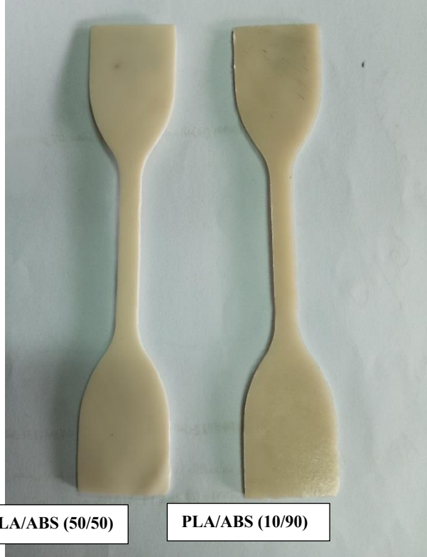
الشكل (4): العينات التي اجري عليها اختبارات الشد
