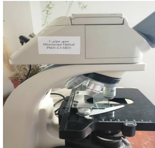
الشكل (8.3): المجهر الضوئي المستعمل لعد الآثار على الكواشف CR-39.
