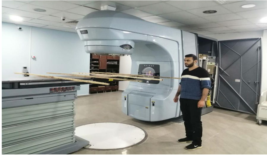
الشكل (12.3) يوضح تخطيطاً توزع العوارض الخشبية الحاملة للكواشف CR – 39 على طاولة المعالجة. في مستشفى تشرين الجامعي باللائقية شعبة المعالجة الإشعاعية.
