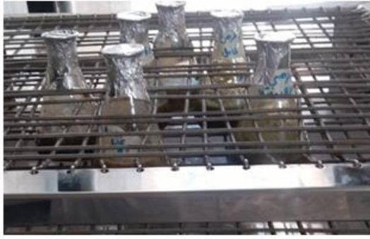
2- ثم الرج لمدة 72 ساعة بسرعة 120 دورة/الدقيقة بدرجة حرارة الغرفة.
