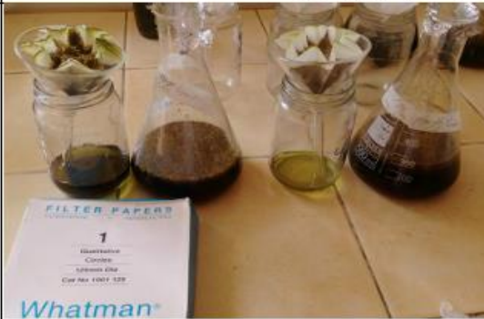
3- ثم الترشيح بورق Whatman NO.1 لفصل المستخلص عن المادة النباتية.
