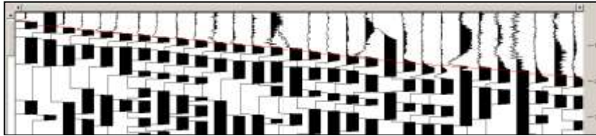
الشكل (5) الحقل الموجي للأمواج الطولية والتقاط أزمنة الوصول الأولية للبيئر (BH_01).
