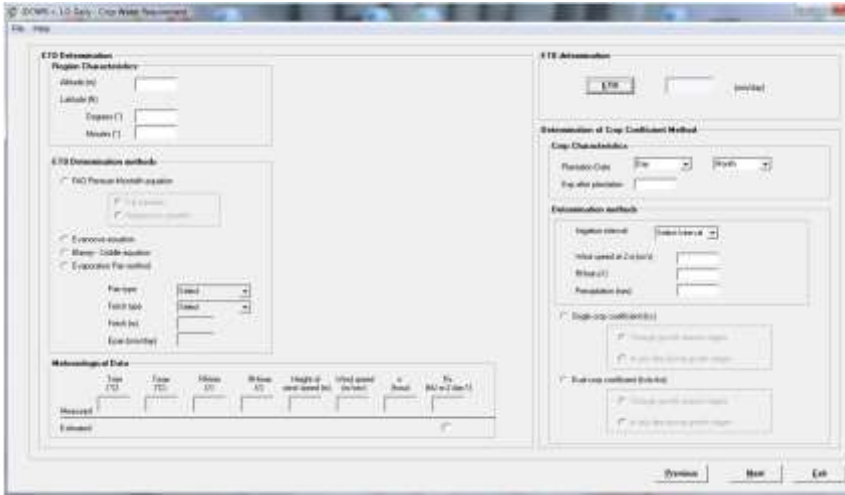
الشكل (2) الواجهة الخاصة بطرائق حساب التبخر-نتح المرجعي ( ET_0 )
