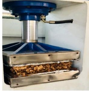
الشكل (3) معاملة فرشاة الرقائق بالمكبس الحراري
