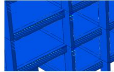
الشكل (37) الإجهادات الأعظمية نتيجة الزلزال في بيتون البناء بعد التقوية والوصل عند الزمن (10.3 sec) (MPa).
