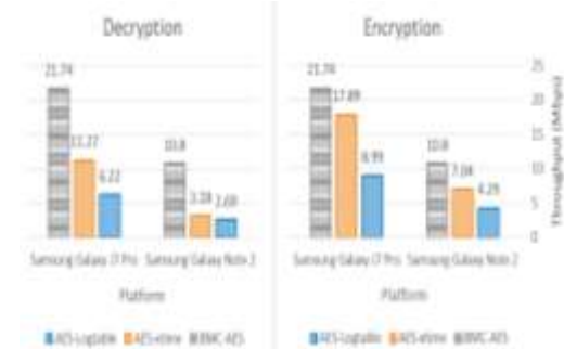
الشكل (14) مردود التشفير وفك التشفير باستخدام مفتاح 128 بت على منصّة جهازٍ محمول
